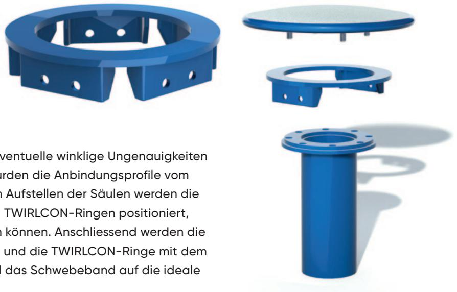
Um die Montage zu vereinfachen und eventuelle winklige Ungenauigkeiten bei den Standsäulen auszugleichen, wurden die Anbindungsprofile vom Gesamtsystem abgekoppelt. Nach dem Aufstellen der Säulen werden die vormontierten Schwebebänder mit den TWIRLCON-Ringen positioniert, so dass sie sich automatisch ausrichten können. Anschliessend werden die Podiumplatten an den Säulen befestigt und die TWIRLCON-Ringe mit dem Gesamtsystem verklemt. Danach wird das Schwebeband auf die ideale Spannung gebracht.
