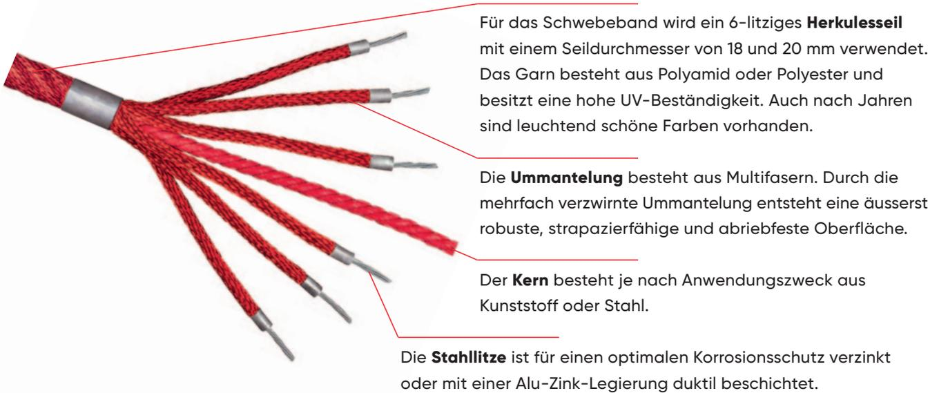
Die robusten Herkulesseile sind mithilfe spezieller Aluminiumpressklammern miteinander verbunden. An den Enden sind flexible Verbindungselemente angebracht, die ein Abknicken und damit vorzeitigen Verschleiss verhindern. Zur Auswahl stehen die Schwebebandvarianten Original, Duplex, Cross oder Pure.
